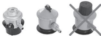
Kuvassa 30 mbar matalapaineensäätimet, jotka ovat oikea valinta kaasugrillille sekä oikealla korkeapaineensäädin, joka on tarkoitettu nestekaasutyökaluiille eikä sitä saa käyttää kaasugrillissä.
