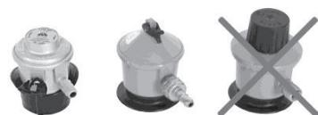
På bilden finns det 30 mbar lågtrycksregulatorer, som är rätt val till gasgrillen samt till höger en högtrycksregulator som får användas endast till gasverktyg. Använd inte den till gasgrillar.
