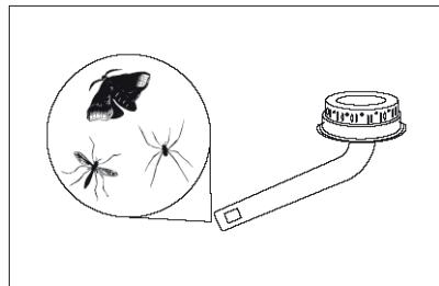
Hvis dette inntrer, sett bryterne i stilling "OFF" og vent til grillen er blitt kald. Når den er kald kan du løsne brennerne og rengjøre venturierøret med børste og piperenser. Monter tilbake brennerne og forsikre deg om at de entrer inn på gassventilene med dyser.
