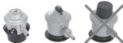
Kuvassa 30 mbar matalapaineensäätimet, jotka ovat oikea valinta kaasugrillille sekä oikealla korkeapaineensäädin, joka on tarkoitettu nestekaasutyökaluille eikä sitä saa käyttää kaasugrillissä.
